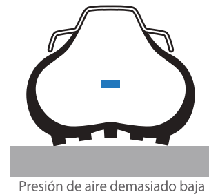
Presión de aire demasiado baja
