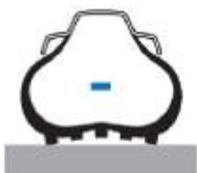
Presión de aire demasiado baja
