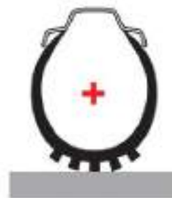
Presión de aire demasiado alta
